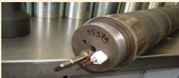
Рис. 8. Установка датчиков температуры в СПТП Завода 5
