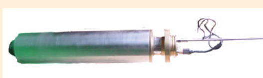
Рис. 7. Установка датчиков температуры в СПТП Завода 4
