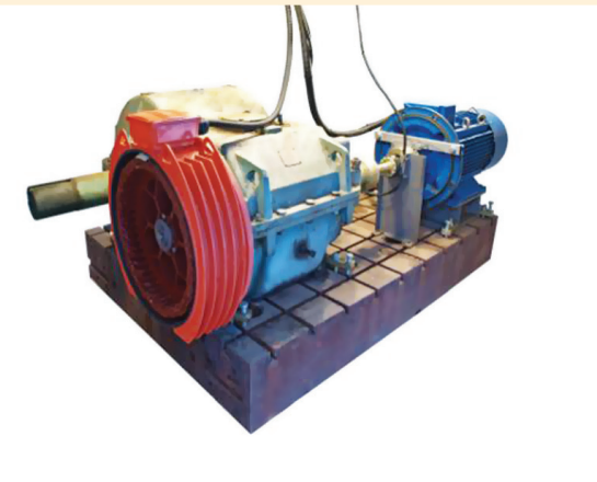
Рис. 4. Нагрузочный стапель стенда испытаний вентильного электродвигателя ВДПМ-СК-22В
